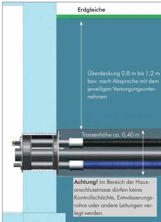
Abb. 4: Einbau Quadro-Secura® K-FW
