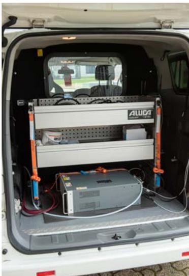
Das System ist so eingestellt, dass es zwischen Methan aus dem Erdgasnetz und Methan aus natürlichen Vergärungsprozessen, wie etwa aus der Kanalisation, unterscheiden kann. Die Reichweite der Messung beträgt ca. 150 Meter. Nachdem das Gasspüffahrzeug austretendes Methan festgestellt hat, geht es im zweiten Schritt daran, herauszufinden, wo genau es herkommt. Diese Aufgabe übernimmt ein Handsensor, der die Leckagen punktgenau lokalisieren kann.
